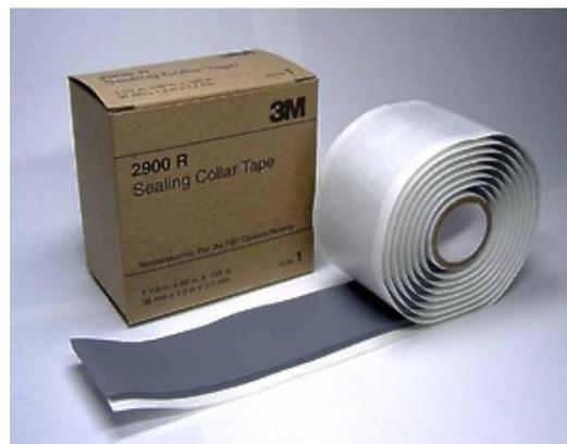
Применяется для выравнивания поверхностей при герметизации, гидроизоляции оболочек, муфт кабелей и защите от коррозии, совместно с изоляционными лентами, имеющими твердую основу. Очень легко формуется, прекрасная защита от проникновения влаги внутрь соединения. Данная мастика не электропроводна, легкоформируемая, устойчива к растворителям и поддерживает форму до 140 С.
