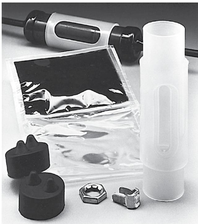
Комплект 3832 для соединения сервисных кабелей обеспечивает соединение до пяти пар незаполненного или заполненного гидрофобным наполнителем кабеля. В комплект также входит один пакет компаунда 4403 размера «А» и расщепленный болт. После заливки компаунда внешняя трубка поворачивается вокруг внутренней, герметизируя таким образом заливное отверстие. В результате экономится время на ожидание затвердевания компаунда перед помещением муфты в землю.
