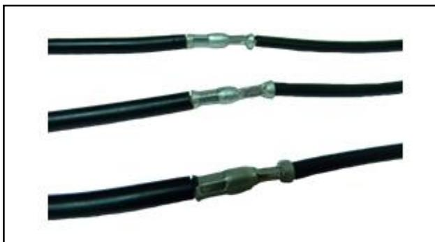
Соединение проводов двух разных сечений осуществляется с использованием медной луженой гильзы, причем гильза (соединитель), подбирается по большему сечению кабеля!
