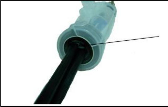
При закрывании корпуса необходимо проверить насколько плотно к проводам прилегает электроизоляционная мастика Scotchfil и уплотнитель.
