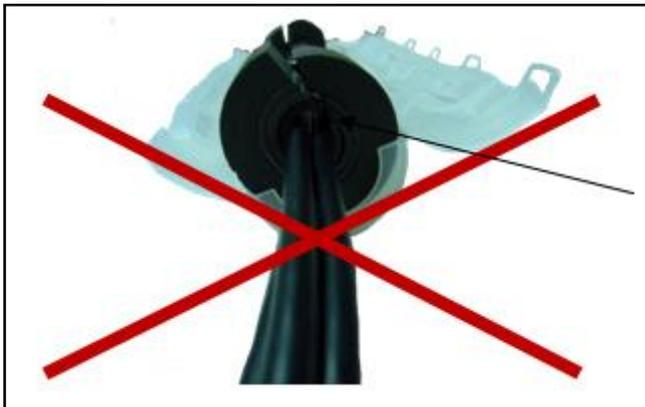
Обратите внимание, что при соединении нескольких проводов в одной муфте уплотнитель неплотно прилегает к оболочке провода, что может привести к вытеканию компаунда!
